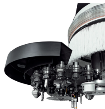
RAPID 16 – zadní rotační zásobník
