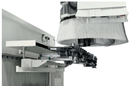
FAST 14 – zásobník u elektrovřetene
